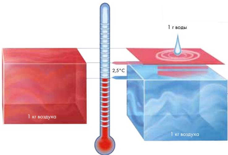
Испарение 1 грамма воды в 1 килограмме воздуха понижает его температуру на 2,5 °C.
