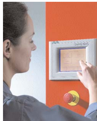
Простым нажатием кнопки сформированный слой коробок переставляется на палету.
