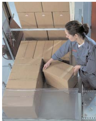
Оператор устанавливает коробки на подготовительной платформе в соответствии с установленным образцом.
